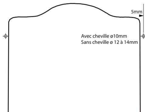
Plaque appuyée contre le mur sur toute la surface, déterminer la hauteur de la fixation dans le tiers supérieur ou en dessous de l'épaulement.
